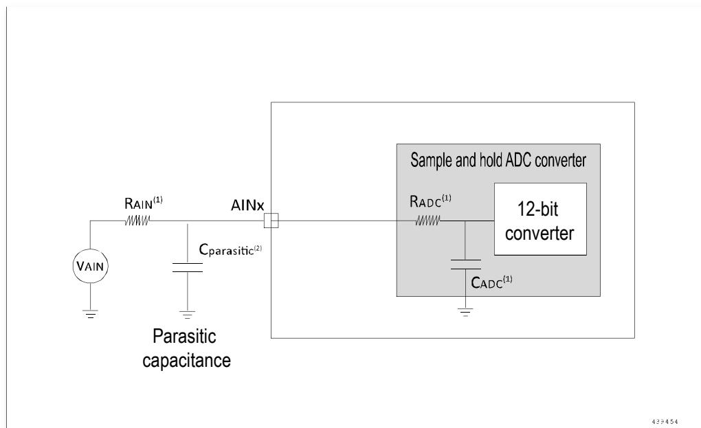
图 5-15 使用 ADC 典型的连接图
