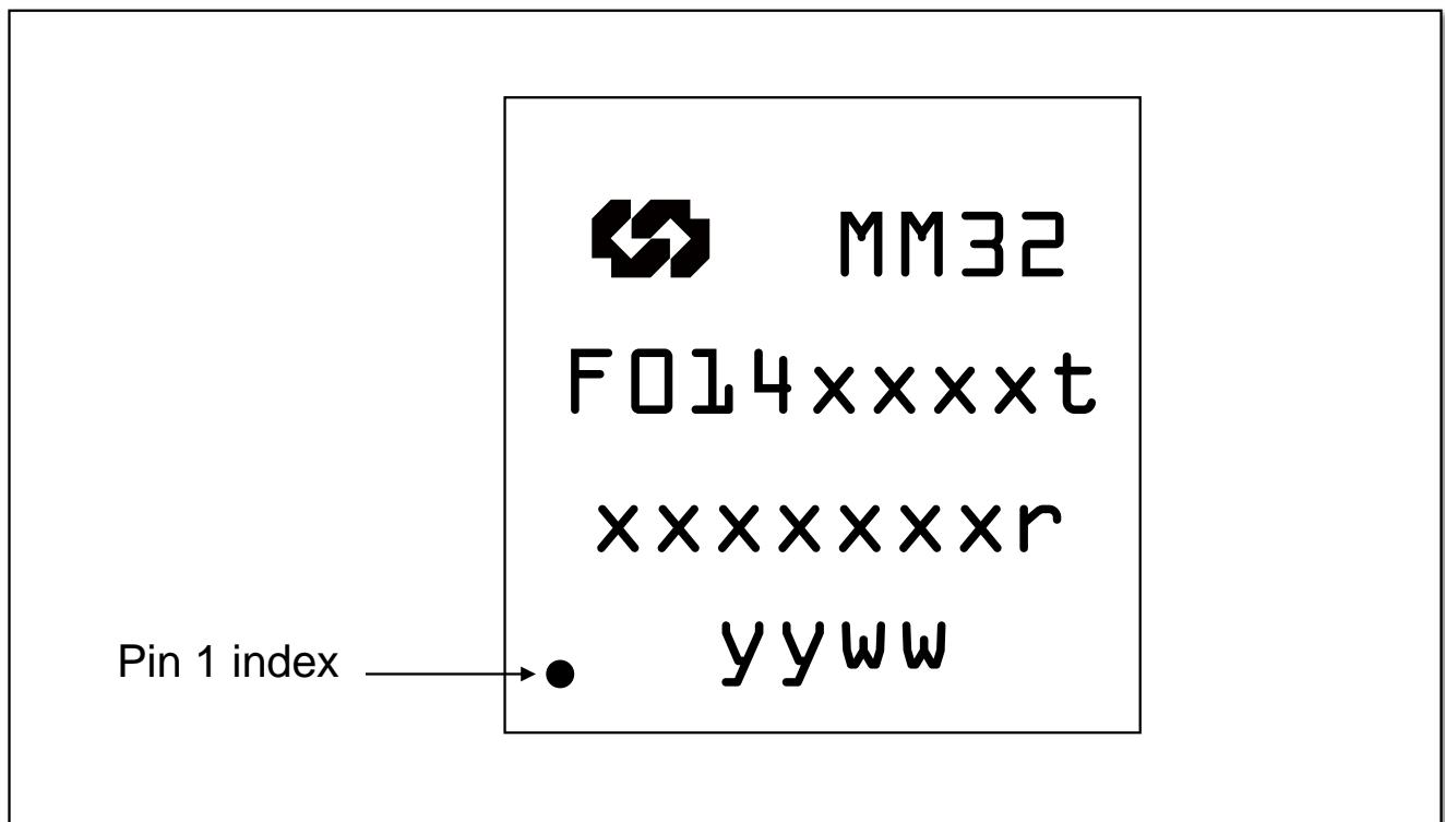
图 2-1 LQFP 和 QFN32 封装丝印
