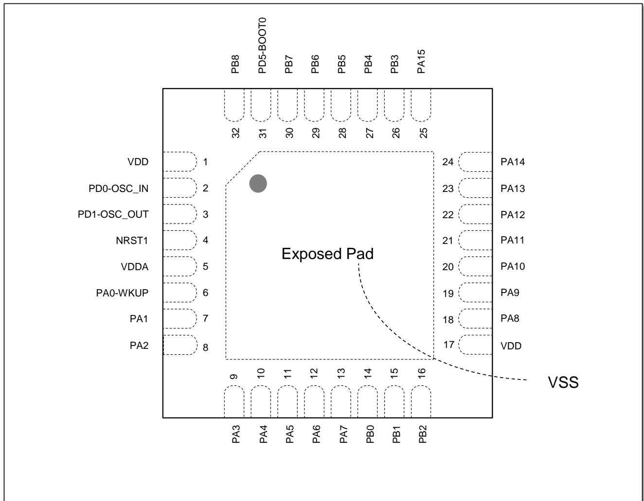
图 4-3 QFN32 5x5 mm<sup>2</sup> 引脚分布
