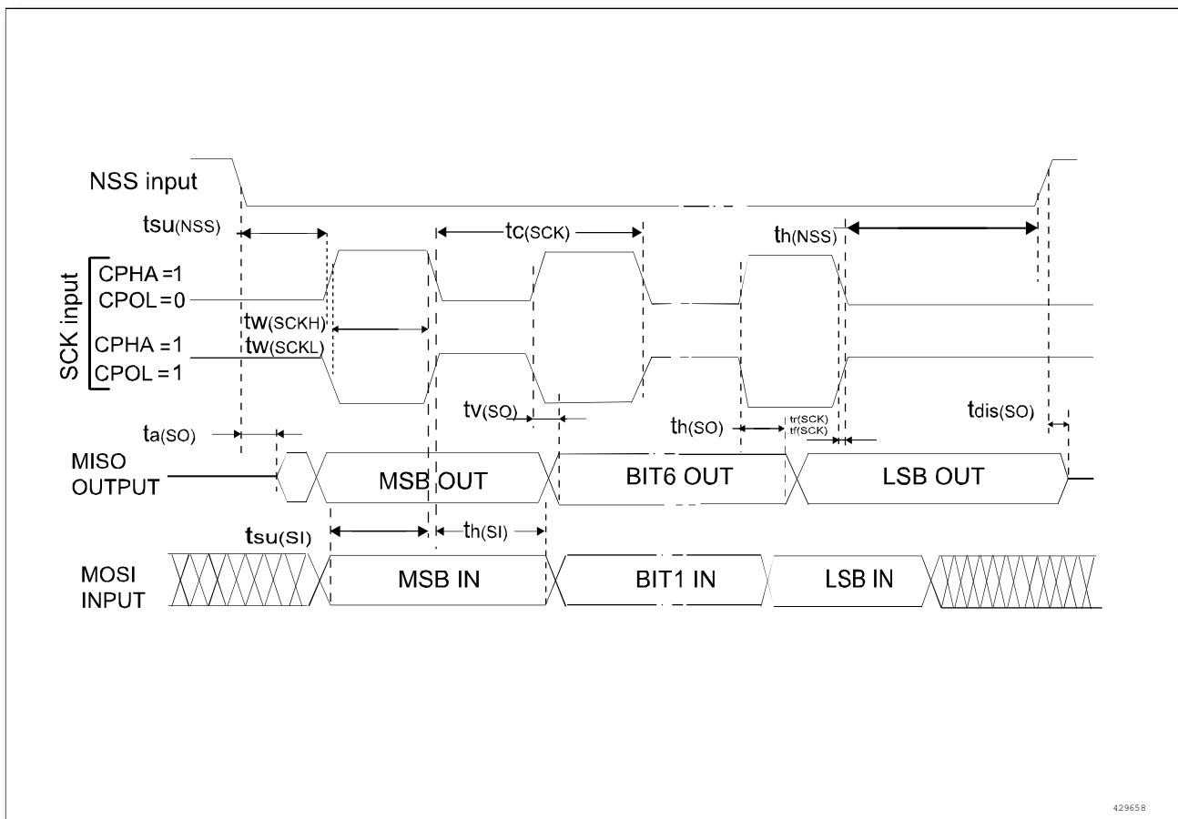
图 5-12 SPI 时序图从模式和 CPHA = 1, CPHASEL = 1<sup>(1)</sup>
