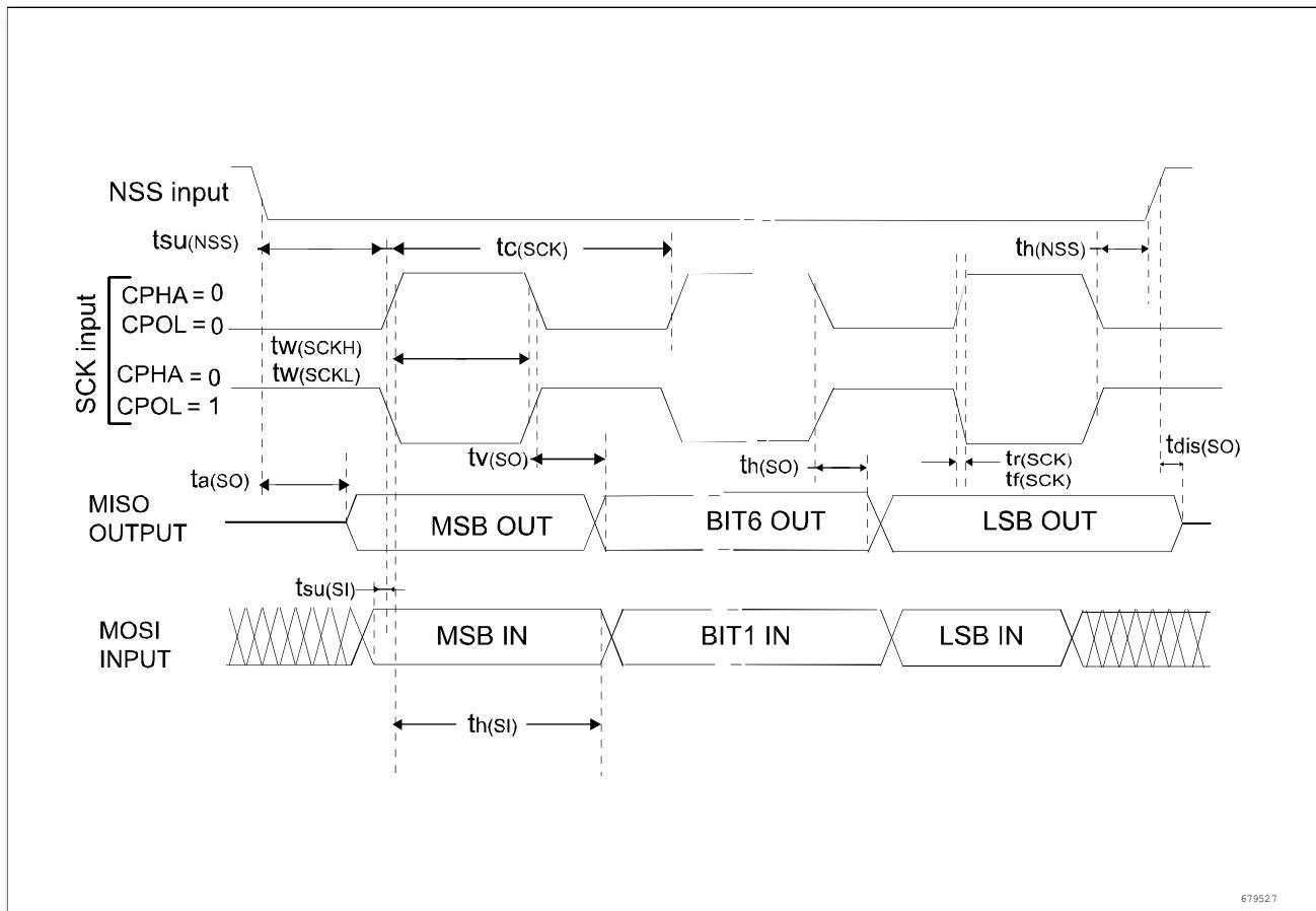
图 5-11 SPI 时序图从模式和 CPHA = 0, CPHASEL = 1
