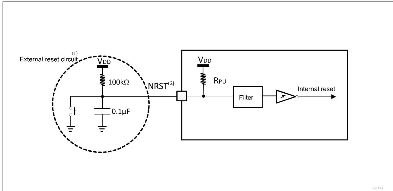
图 5-9 建议的 NRST 引脚保护
