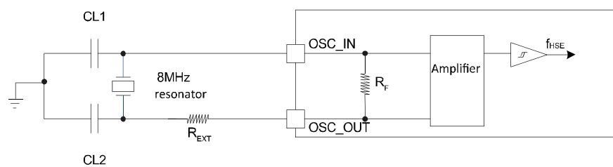
图 5-7 使用 8MHz 晶体的典型应用
