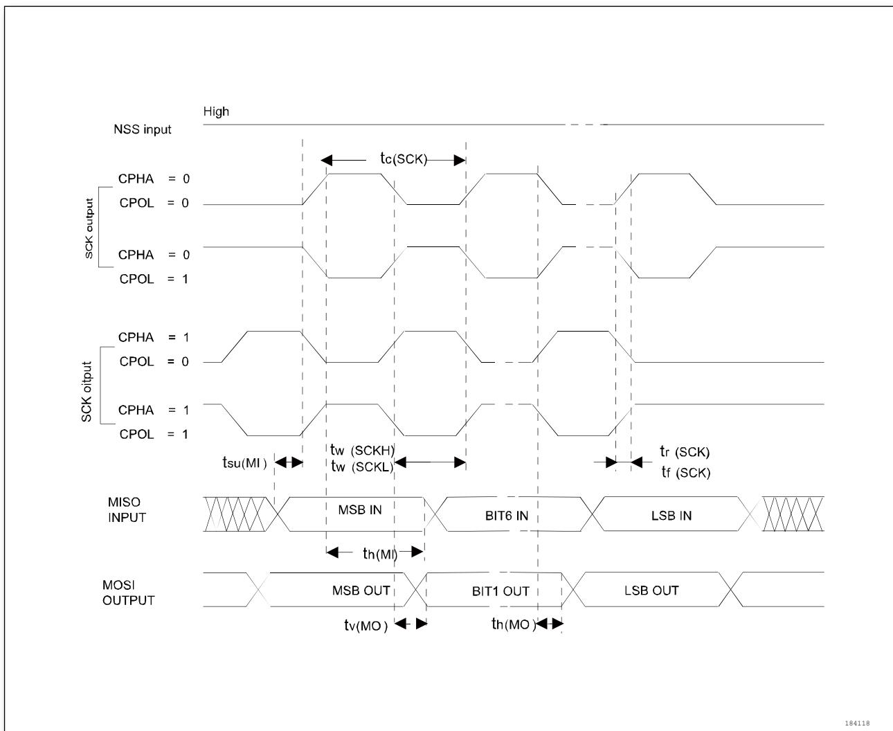
图 5-13 SPI 时序图主模式， $\text{CPHASEL} = 1$ <sup>(1)</sup>
