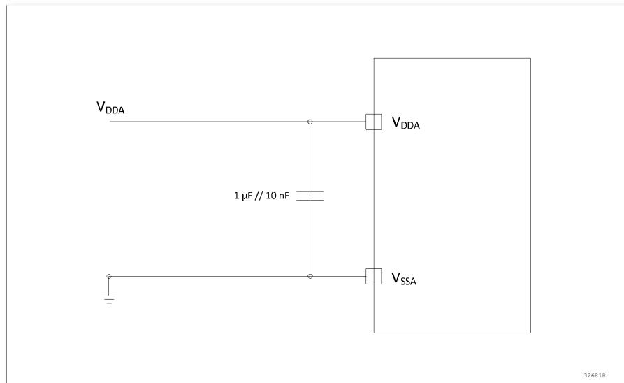
图 5-16 供电电源和参考电源去耦线路
