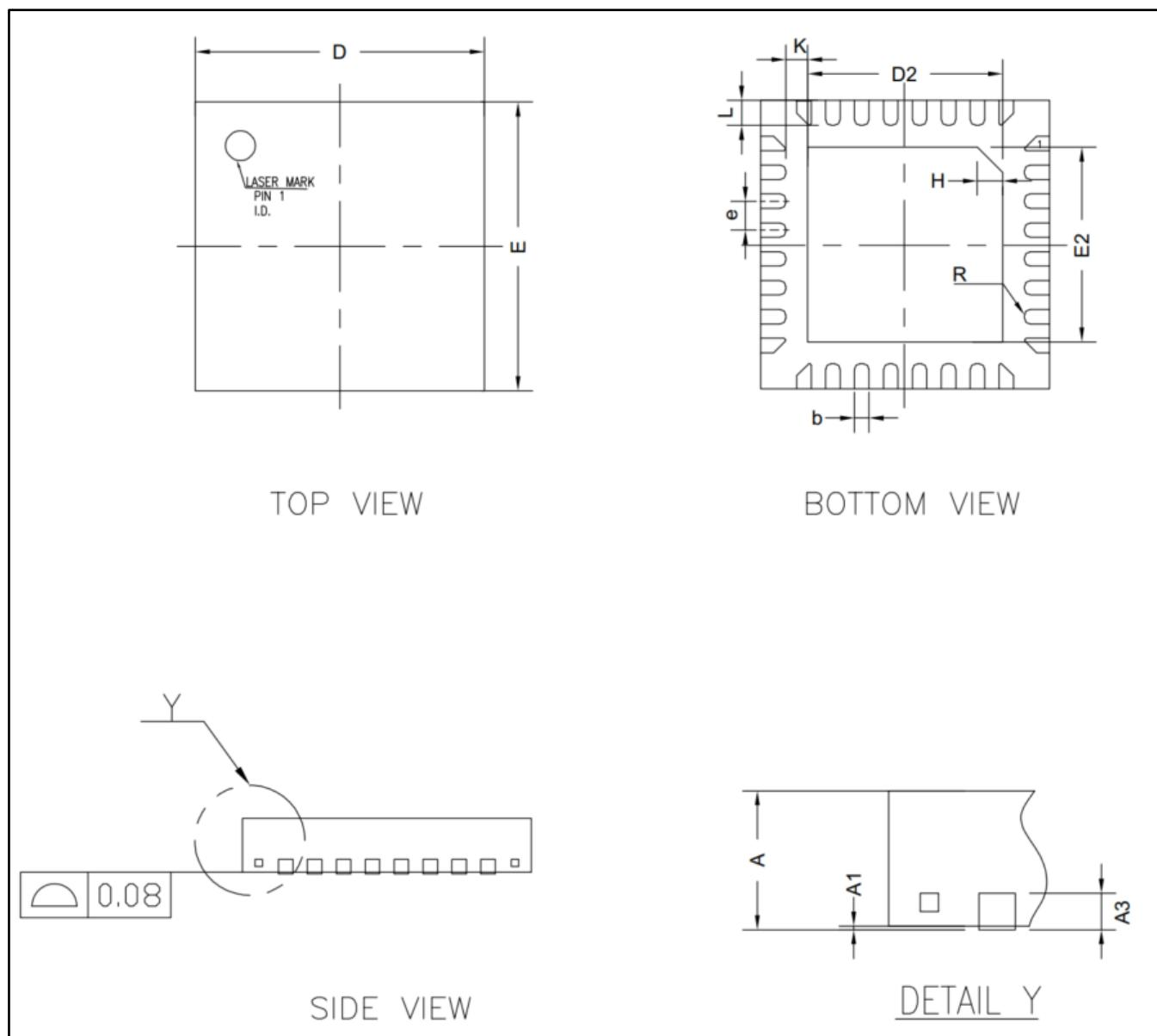
图 6-4 QFN32 4x4 mm2 封装尺寸
