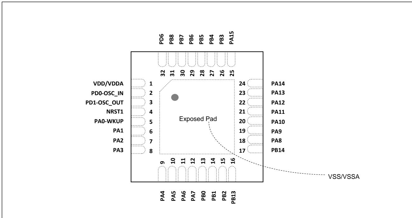
图 4-4 QFN32 4x4 mm<sup>2</sup> 引脚分布
