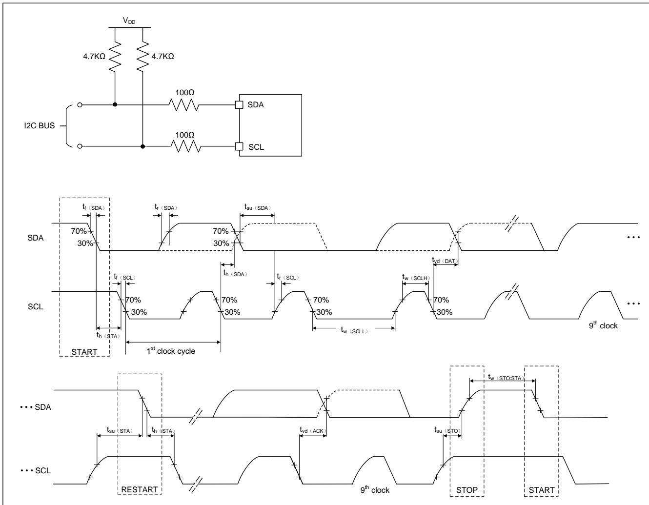
图 5-10 I2C 总线交流波形和测量电路 (1)
