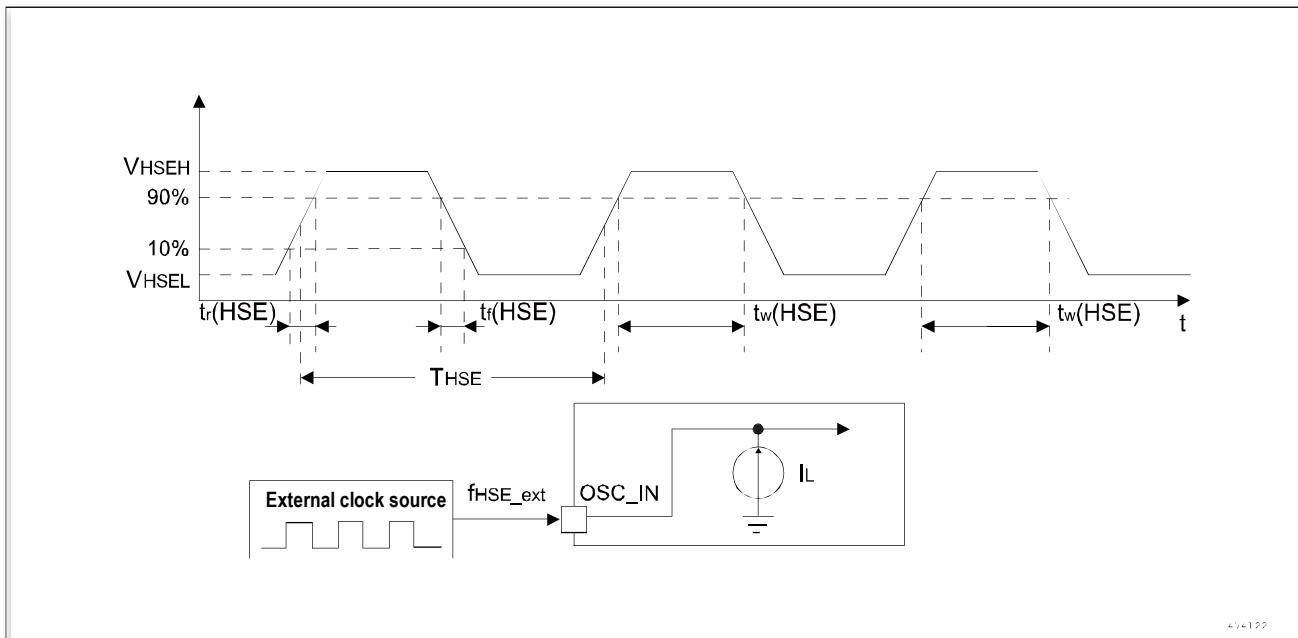
图 5-6 外部高速时钟源的交流时序图
