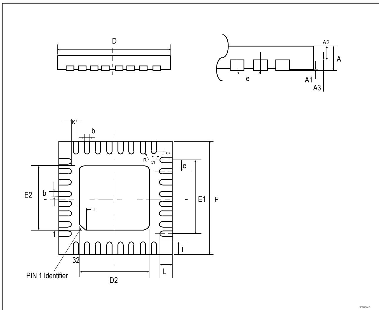
图 6-3 QFN32 5x5 mm2 封装尺寸
