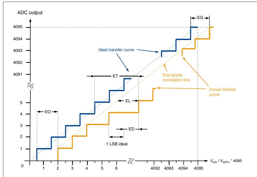
图 5-12 ADC 静态参数示意图
