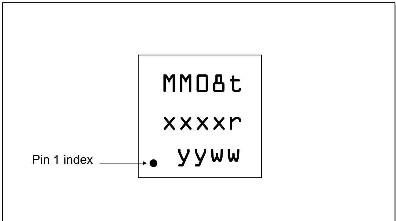
图 2-2 QFN20 封装丝印
