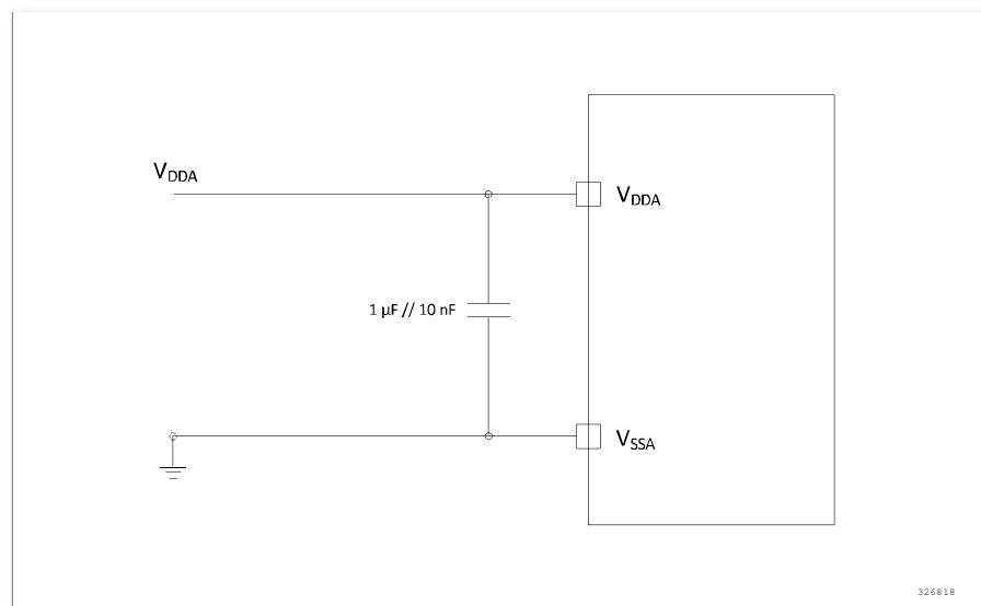
图 5-14 供电电源和参考电源去耦线路
