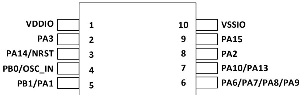
图 4-5 MSOP10 引脚分布
