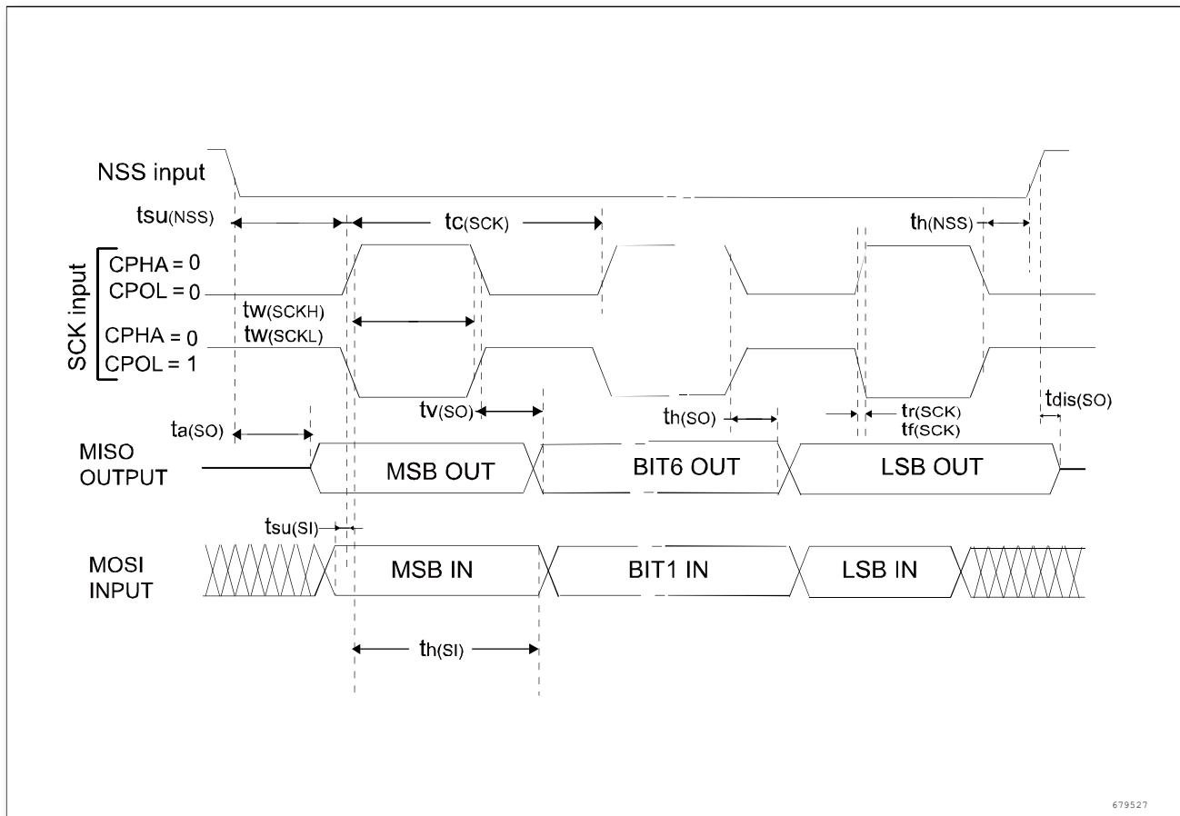
图 5-9 SPI 时序图从模式和 CPHA = 0, CPHASEL = 1
