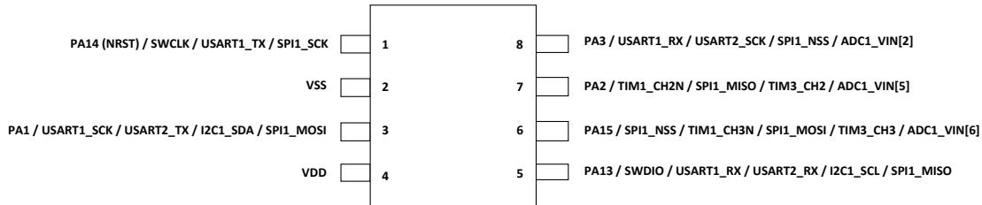
图 4-3 SOP8 – type 0 引脚分布
