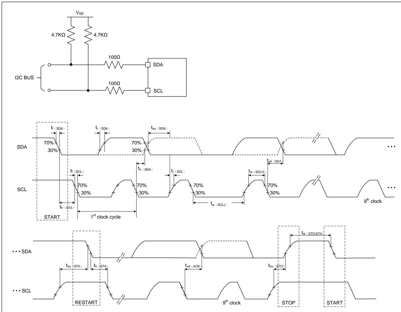
图 5-8 I<sup>2</sup>C 总线交流波形和测量电路<sup>(1)</sup>
