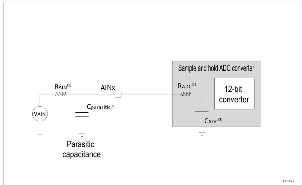
图 5-13 使用 ADC 典型的连接图
