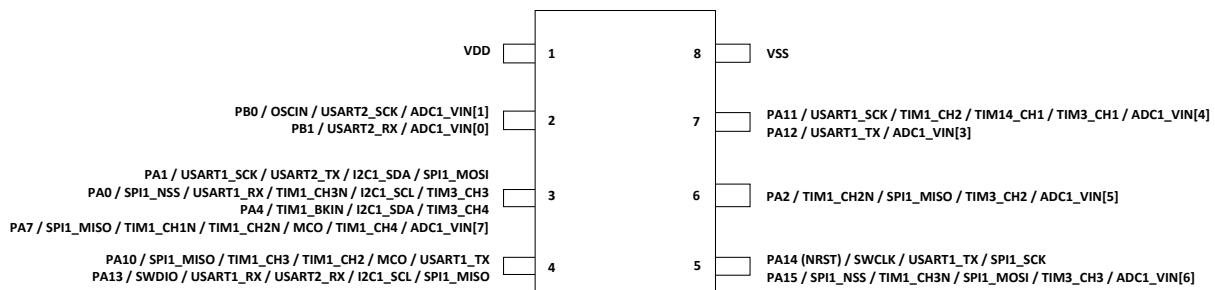
图 4-4 SOP8 – type 1 引脚分布
