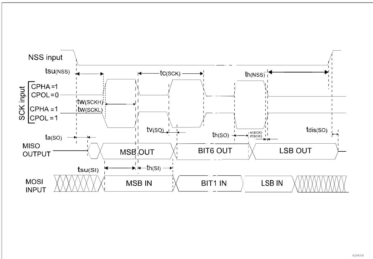
图 5-10 SPI 时序图从模式和 CPHA = 1, CPHASEL = 1<sup>(1)</sup>
