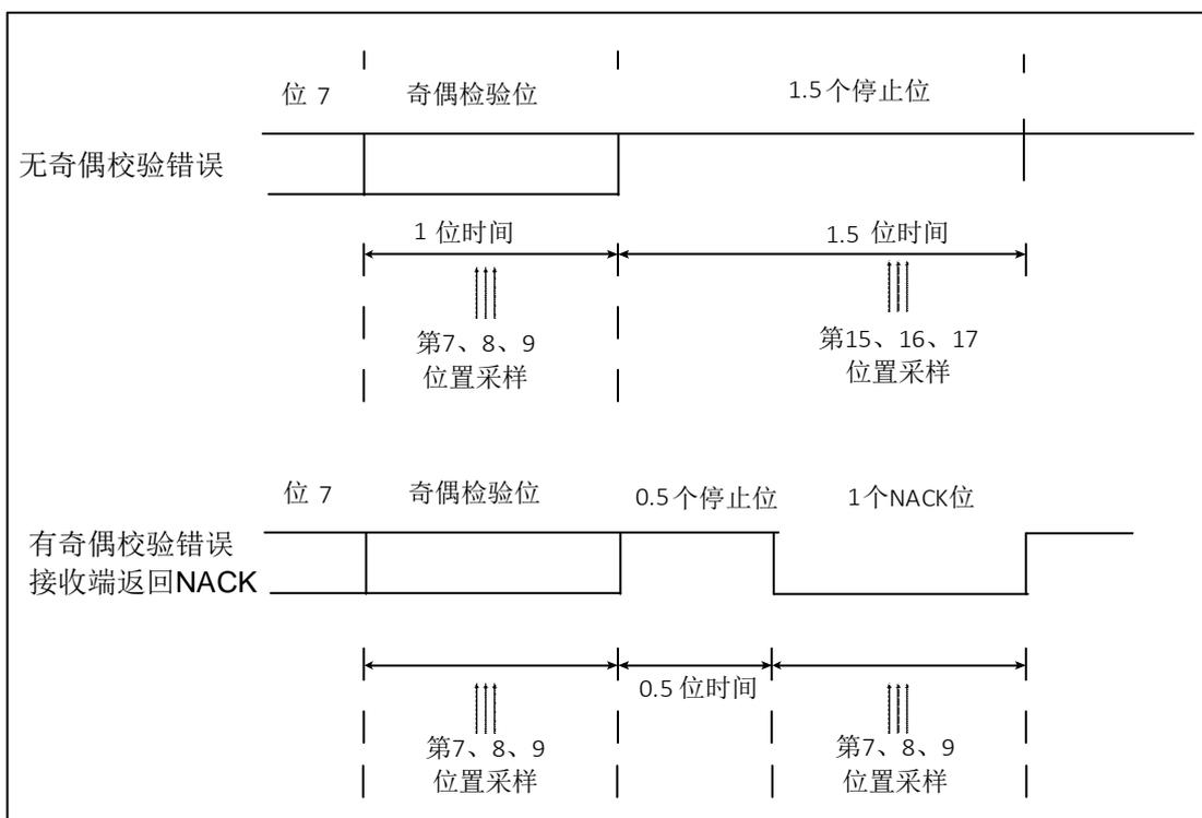
图 20-6 UART 采样 NACK 信号方框图
