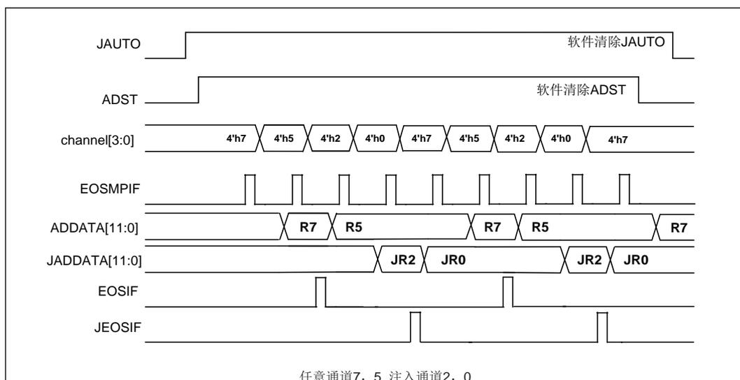
图 12-13 自动注入通道转换连续转换时序图
