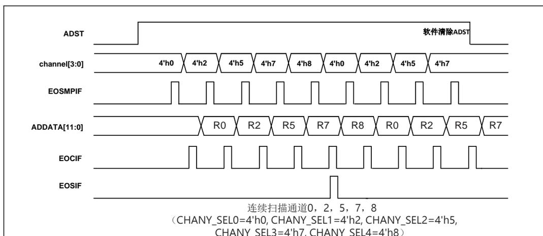
图 12-10 连续扫描模式下通道转换时序图
