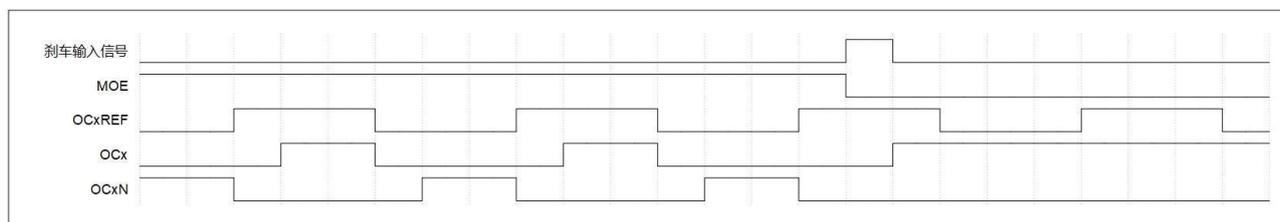
图 13-27 响应刹车的输出 (OISx=1, OISxN=0)
