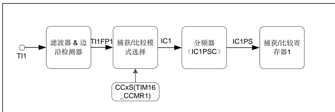
图 17-5 TIMx 输入捕获结构图
