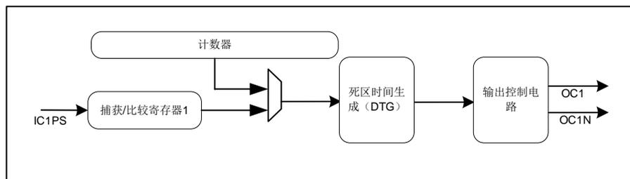
图 17-6 比较输出部分结构图
