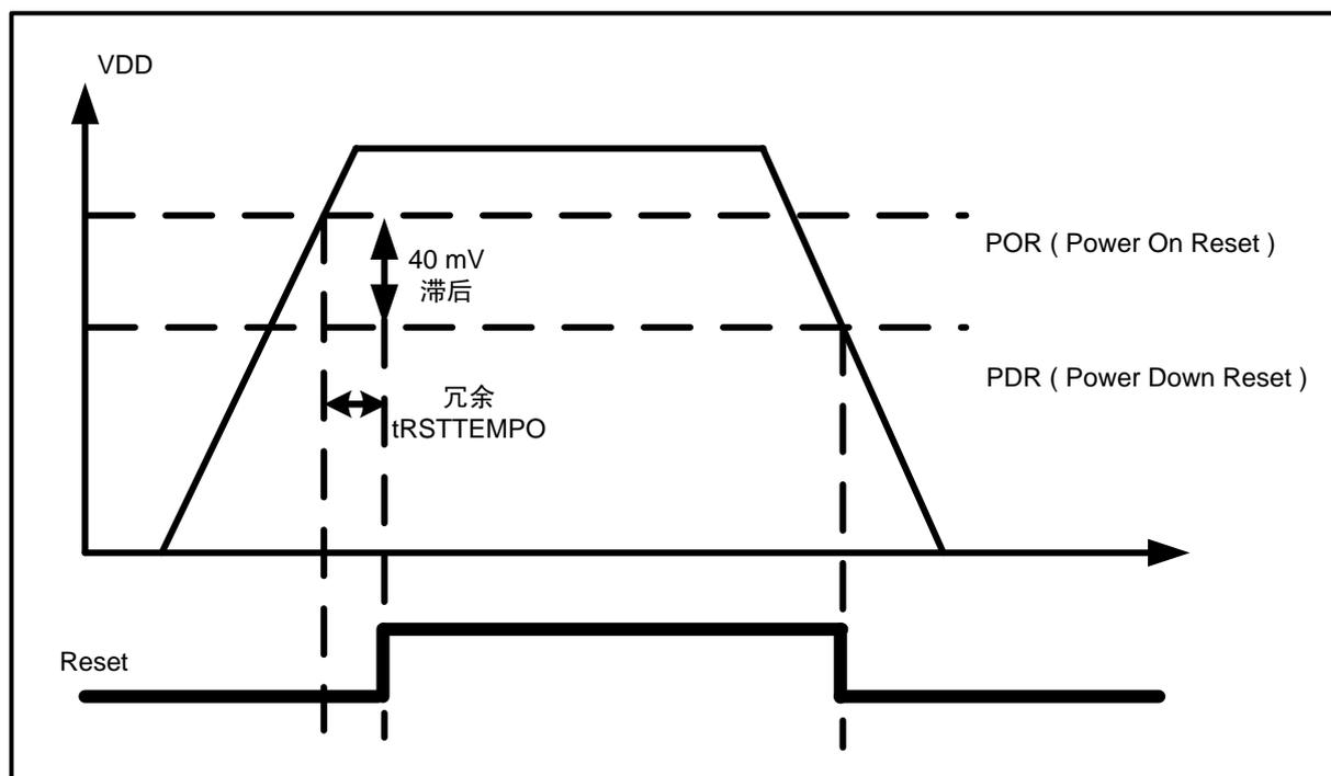
图 3-2 上电复位和掉电复位波形图
