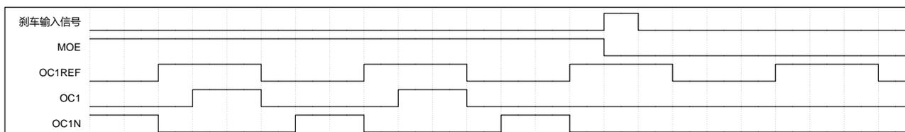
图 17-10 响应刹车的输出 (OISx=0, OISxN=0)
