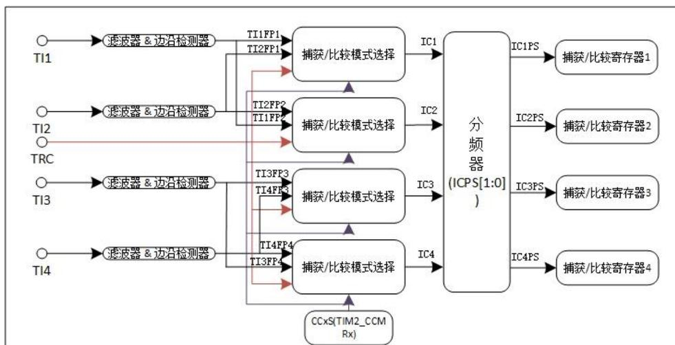
图 14-12 TIM2 输入捕获结构图
