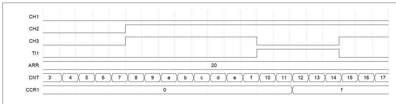
图 14-27 (TI1 异或输入) 输入捕获波形图
