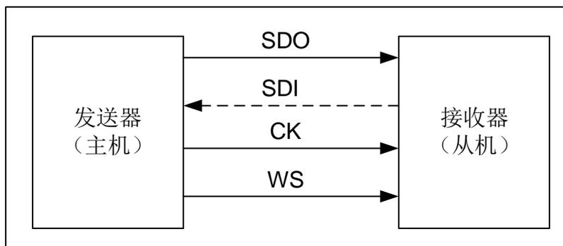
图 21-9 I2S 主模式 (SD 配置成 SDO 为发送器, 配置成 SDI 为接收器)
