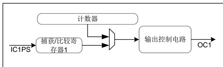
图 16-6 比较输出部分结构图
