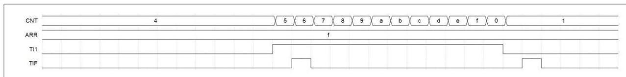
图 15-24 门控模式下的控制时序图
