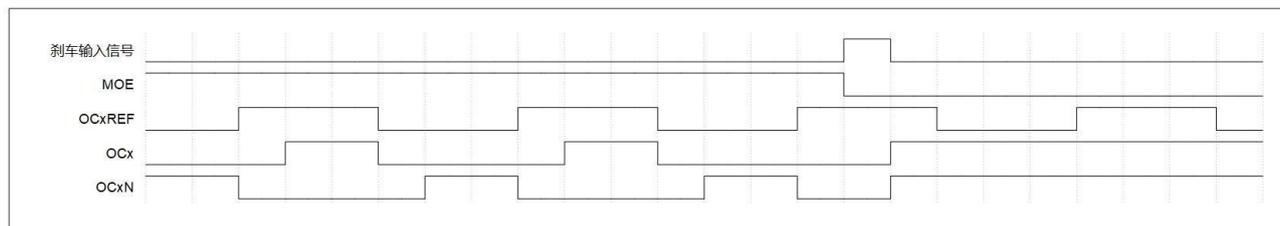
图 13-28 响应刹车的输出 (OISx=1, OISxN=1)
