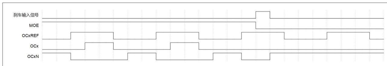
图 13-26 响应刹车的输出 (OISx=0, OISxN=1)
