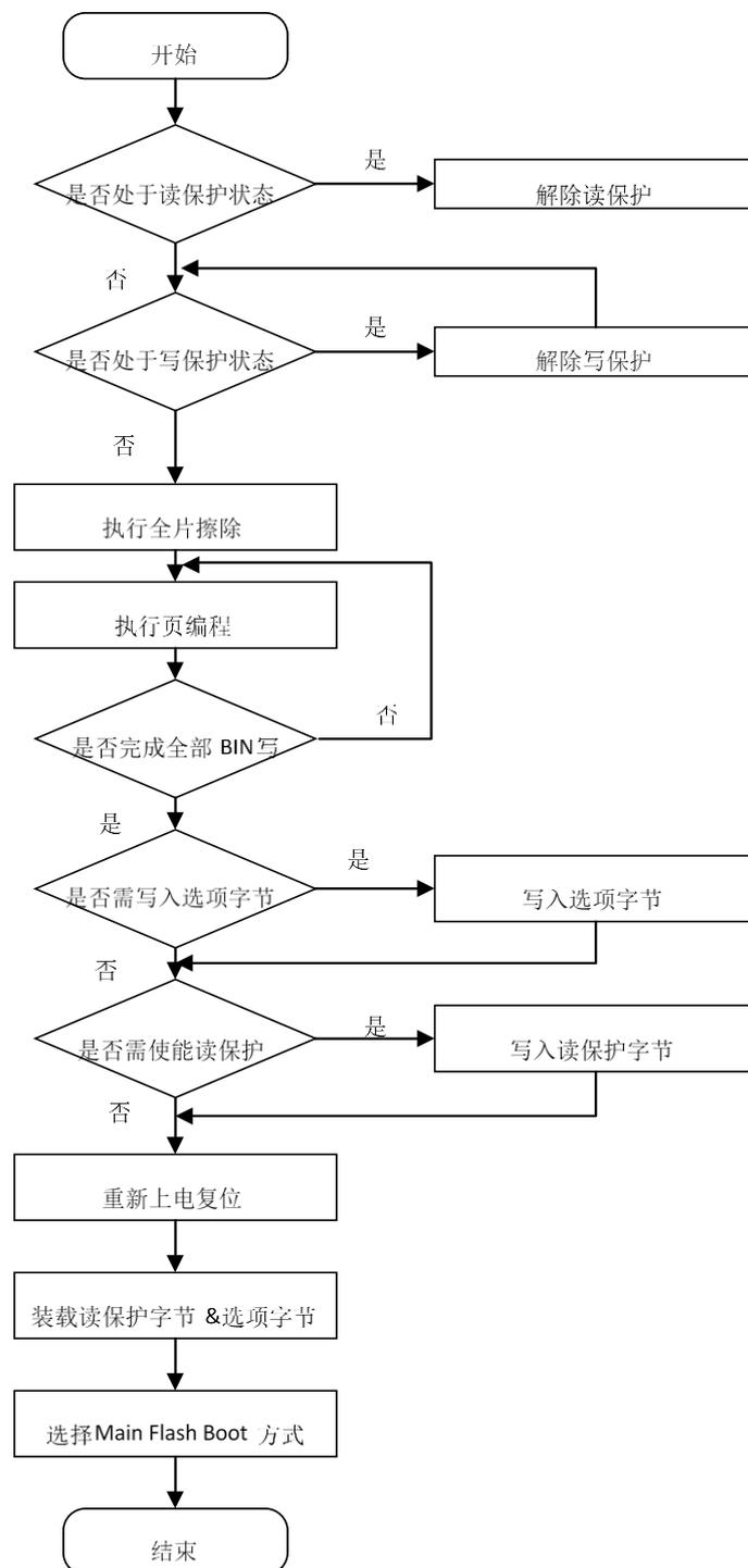
图 2-1 ISP 方式编程流程图
