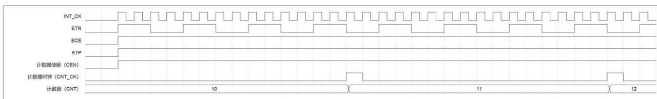
图 15-4 外部时钟模式 2 下的控制电路
