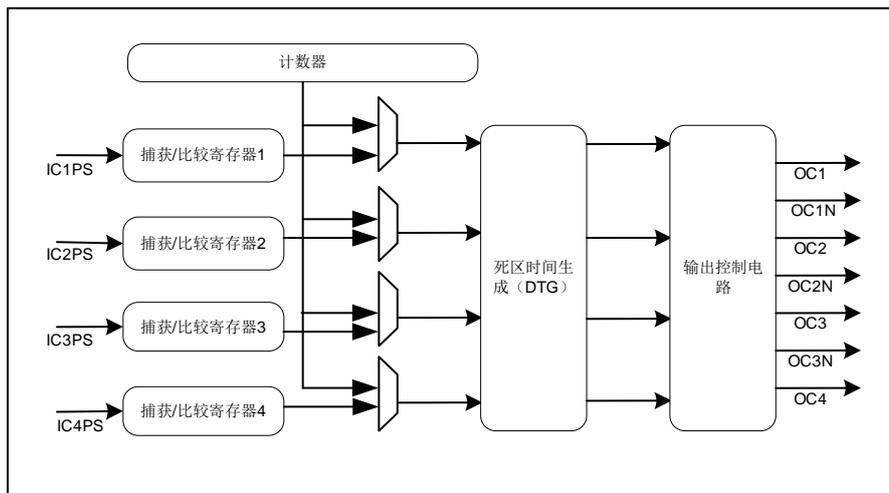
图 13-17 比较输出部分结构图
