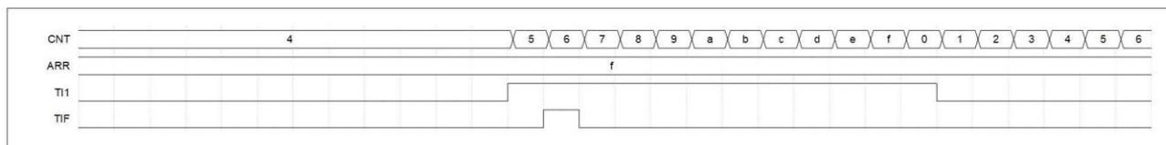
图 14-25 触发器模式下的控制时序图
