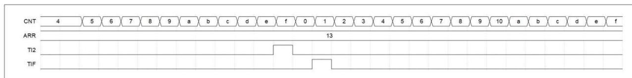
图 13-33 复位模式的控制时序图
