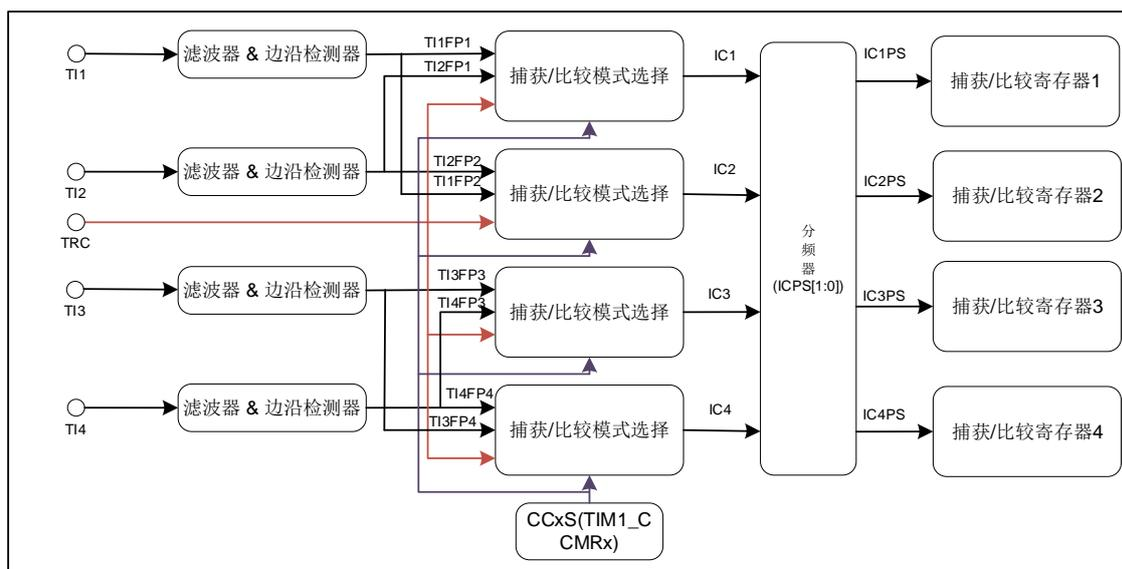
图 13-15 TIM1 输入捕获结构图
