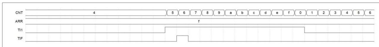
图 13-35 触发器模式下的控制时序图
