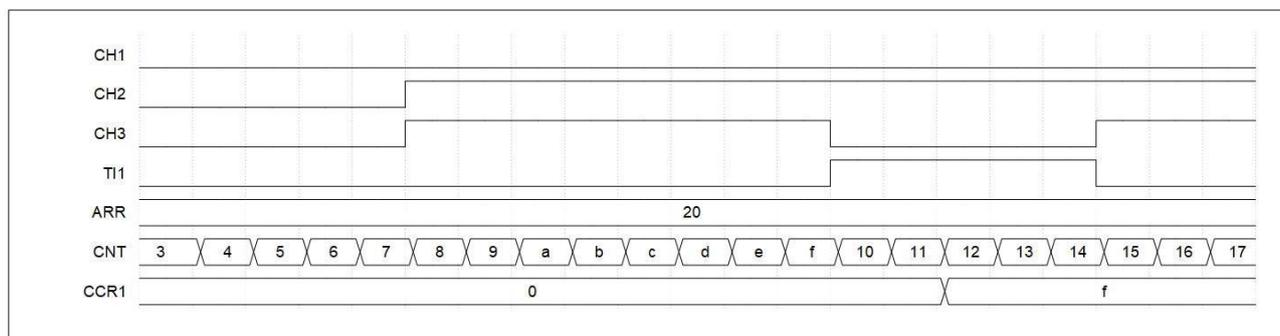
图 13-42 (TI1 异或输入) 输入捕获波形图
