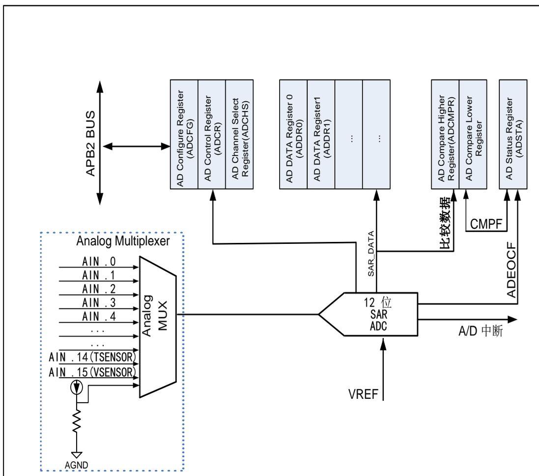
图 12-1 ADC 系统框图
