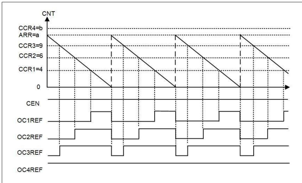
图 13-20 边沿对齐递减计数时 PWM 模式 1 的波形
