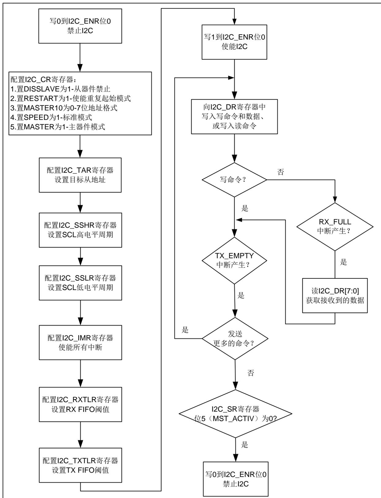
图 22-19 流程图 (I2C 接口作为主器件)
