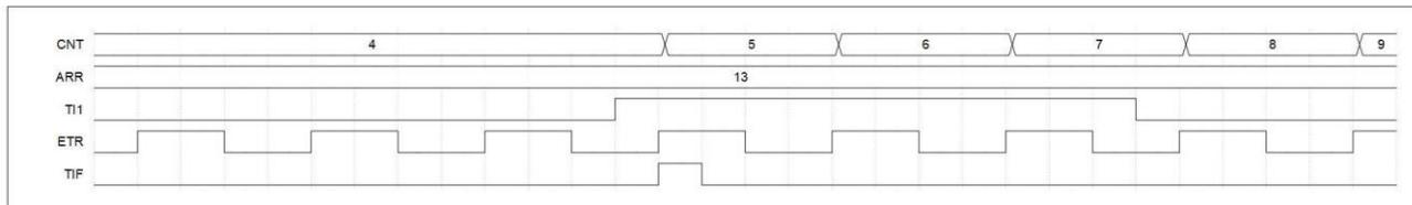
图 14-26 外部时钟模式 2+从模式（触发模式）控制时序图
