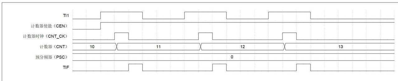
图 14-3 外部时钟模式 1 下的控制电路
