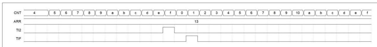
图 14-23 复位模式的控制时序图
