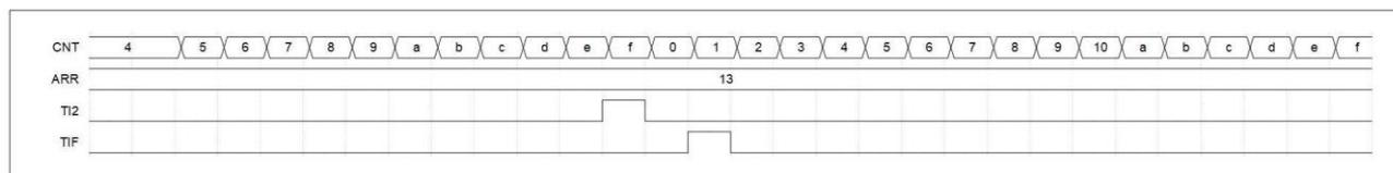
图 15-23 复位模式的控制时序图
