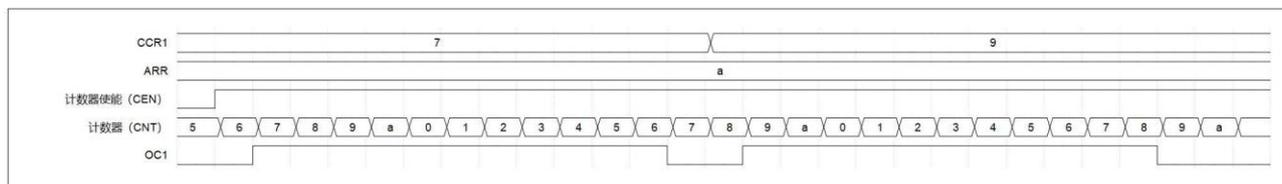
图 13-18 比较输出模式，OC1 信号在匹配时翻转
