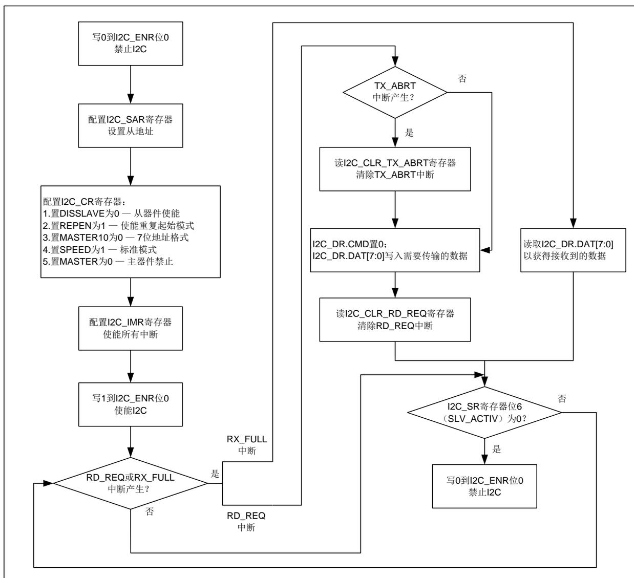
图 22-18 流程图 (I2C 接口作为从器件)
