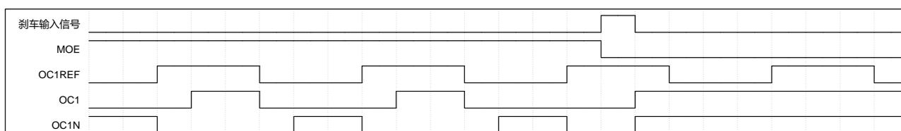
图 17-13 响应刹车的输出 (OISx=1, OISxN=1)
