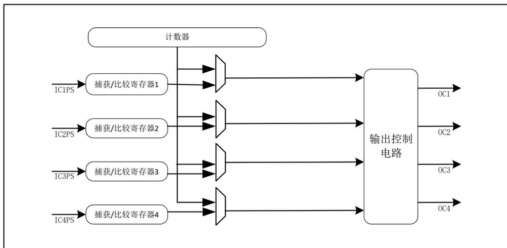
图 15-14 比较输出部分结构图
