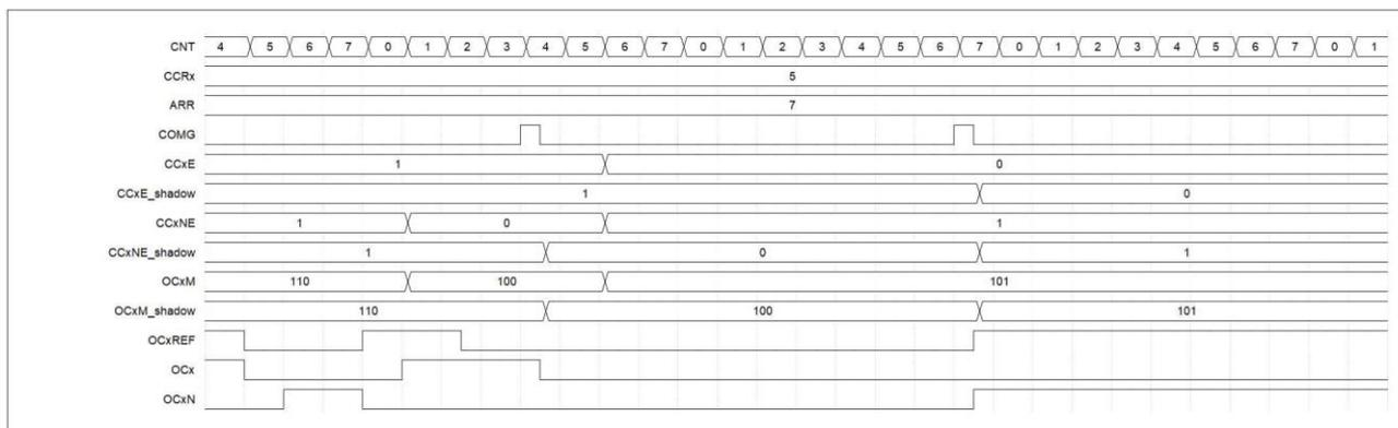
图 13-23 使用 COM 事件产生六步 PWM (OSSR = 1)
