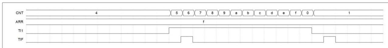
图 13-34 门控模式下的控制时序图
