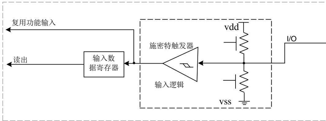
图 8-2 输入浮空/上拉/下拉配置
