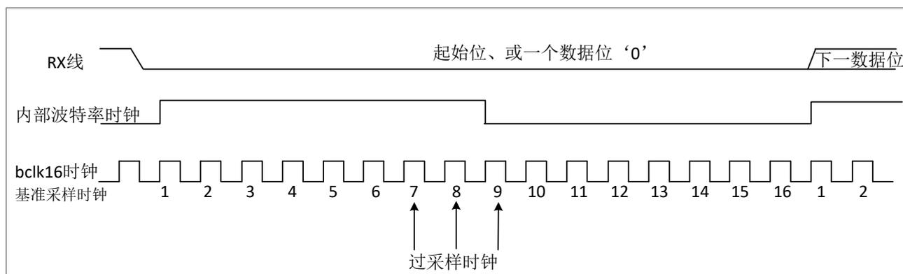
图 20-3 RX 引脚采样方法
