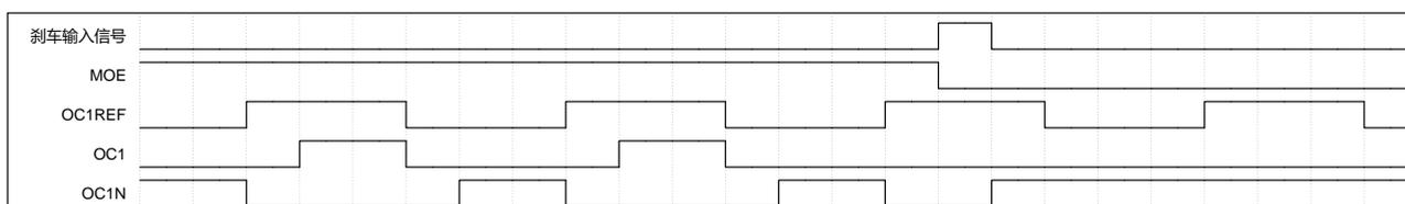
图 17-11 响应刹车的输出 (OISx=0, OISxN=1)
