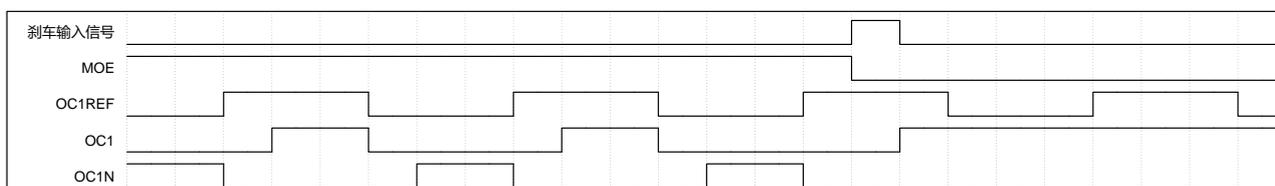
图 17-12 响应刹车的输出 (OISx=1, OISxN=0)
