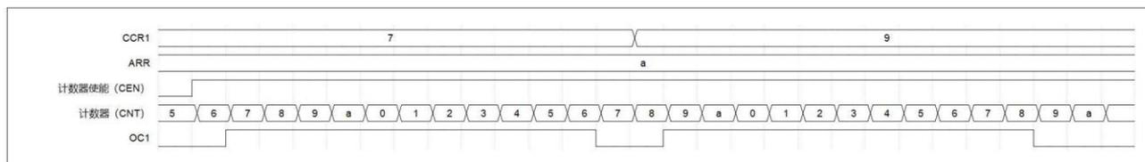
图 14-15 比较输出模式，OC1 信号在匹配时翻转
