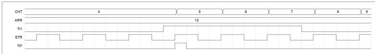
图 13-36 外部时钟模式 2+从模式（触发模式）控制时序图
