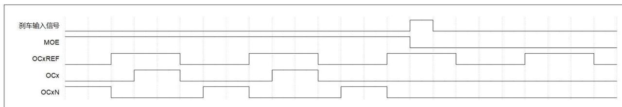
图 13-25 响应刹车的输出 (OISx=0, OISxN=0)
