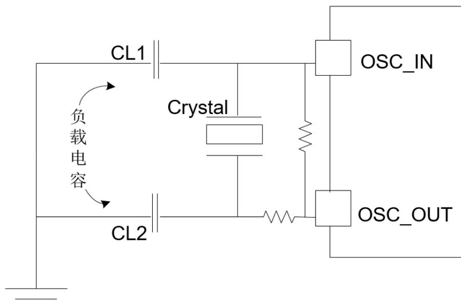
图 5-3 高速晶振/陶瓷谐振器
