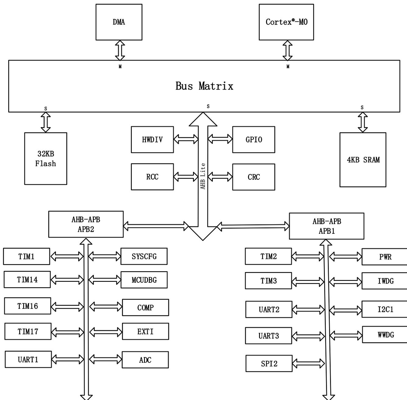
图 1-1 系统架构框图
