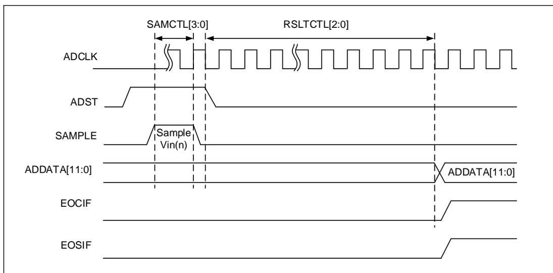
图 12-8 单次转换模式下通道转换时序图
